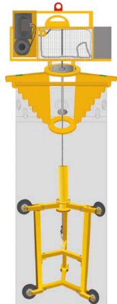
Prinzip des Seilneig-Messgeräts
